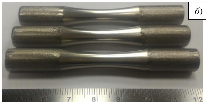
Рисунок 17 – Образцы для определения высокотемпературной прочности: а) на сжатие (цилиндр \varnothing 6 , l = 9 мм); б) на растяжение
