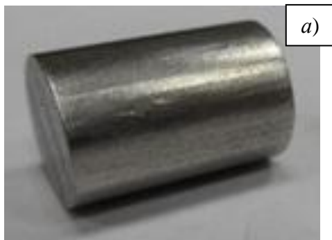
Рисунок 17 – Образцы для определения высокотемпературной прочности: а) на сжатие (цилиндр \varnothing 6 , l = 9 мм); б) на растяжение
